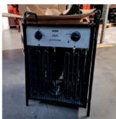
Nagrzewnica elektryczna Skan 20 kW
